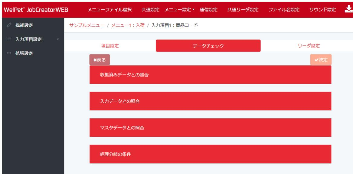
データチェックには「収集済みデータとの照合」「入力データとの照合」「マスタデータとの照合」「処理分岐の条件」の4つの処理を設定することができます。
